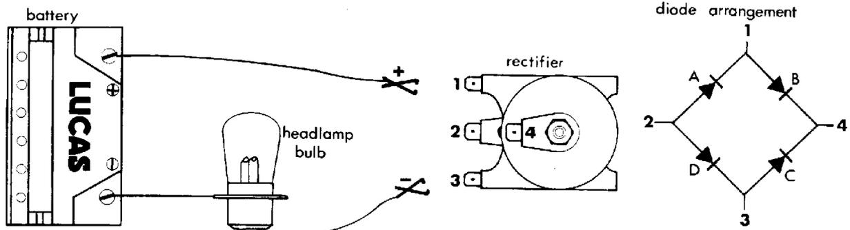
Fig. 69A Rectifier bench test
