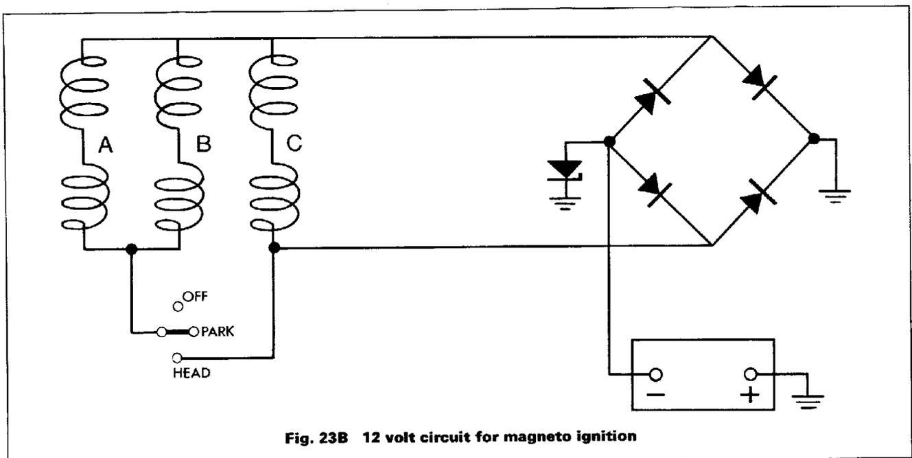
Fig. 23B 12 volt circuit for magneto ignition
