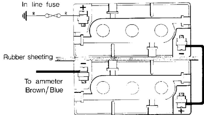
**Fig. 54 Two 6 volt batteries connected for 12 volt operation**
